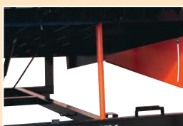
Mástil de apoyo interior abatible para operaciones de mantenimiento
