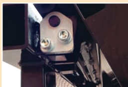
Bisagra trasera sobredimensionada de alta resistencia
